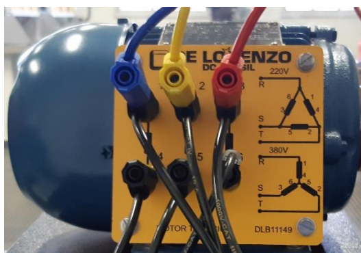
Figura 97 - Ligação Triângulo Executada.
