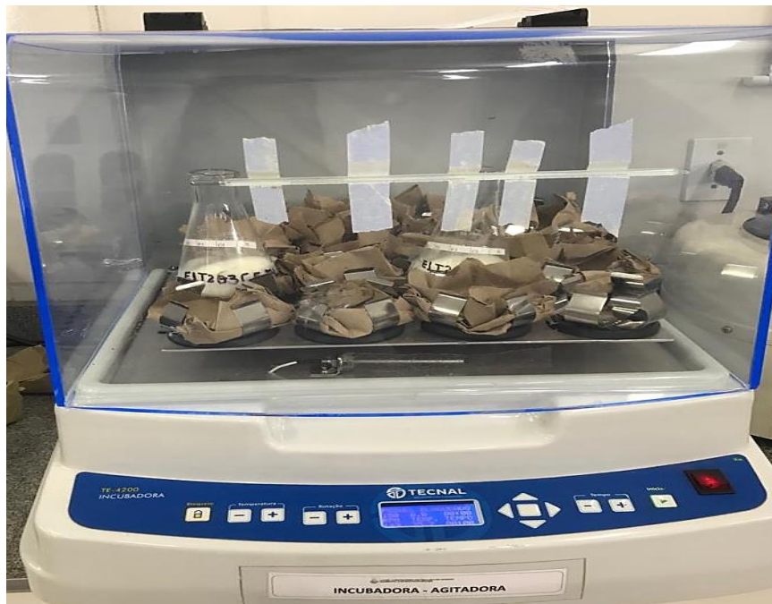
Figura 11 - Hidrólise do leite UHT na incubadora shaker
