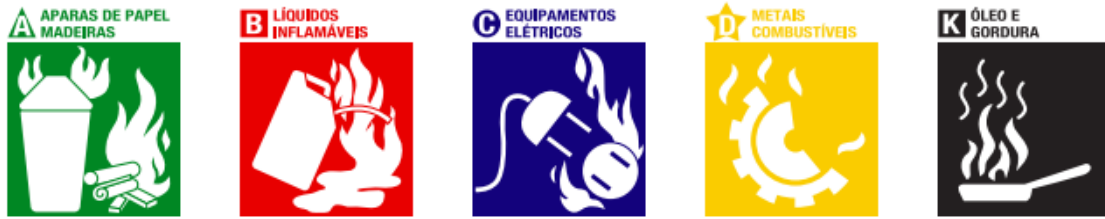
Figura 2 – Simbologia das classes de incêndio
