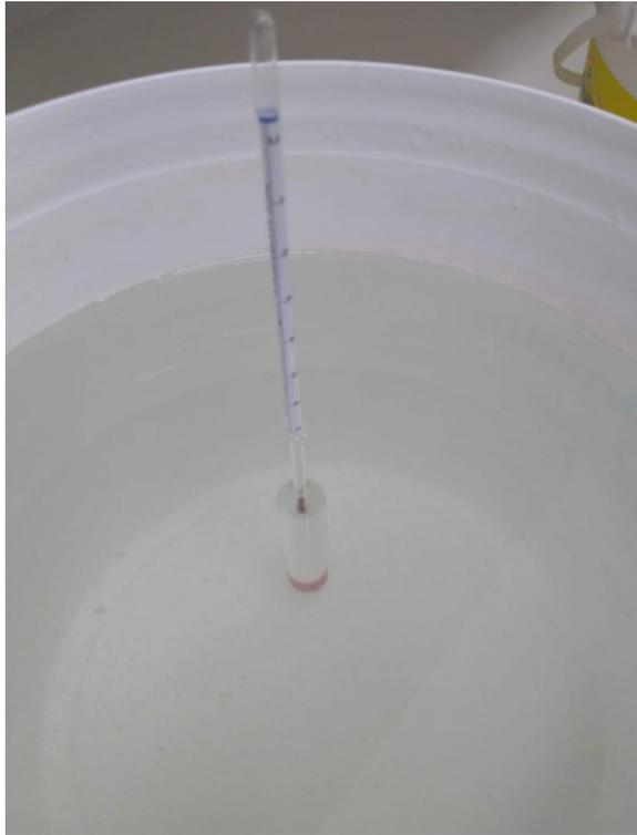
**Figura 7 - Elaboração de soluções salinas de diferentes densidades com auxílio de densímetro.**
