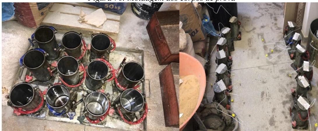
Figura 76: Moldagem dos corpos de prova
