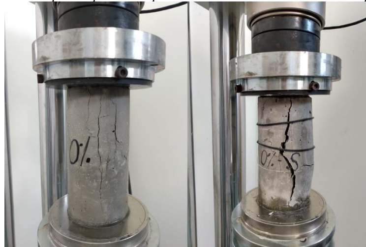
Figura 11: Corpos de prova rompidos no ensaio de resistência à compressão
