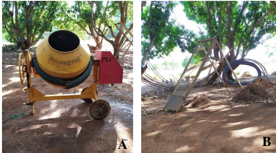
Figura 10 – a) mistura do substrato com betoneira; b) Peneira utilizada para separação do substrato.
