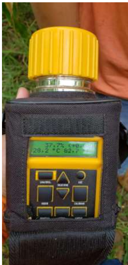
FIGURA 15: Teste de umidade medidor portátil.
