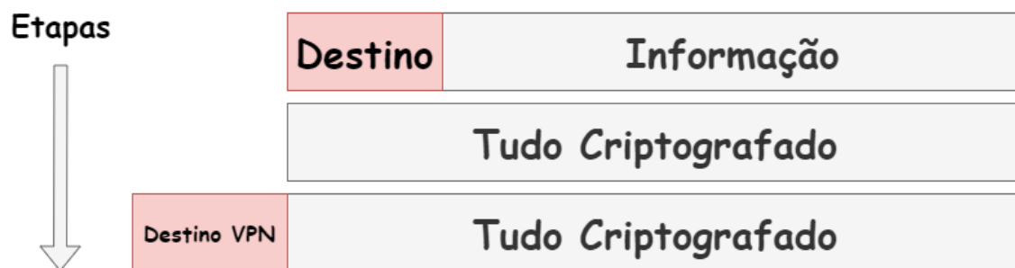
Figura 24 – Etapas do Processo de Tunelamento IP-em-IP
