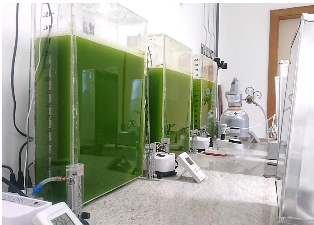
Figura 9 - Cultivo de microalgas em fotobiorreatores air lift de placas planas em acrílico. Os cultivos foram realizados sob iluminação artificial de 35.000 Lux em ciclos de 12h/12h claro/escuro, temperatura de 25°C no escuro e 35°C no claro, aeração de 60L/h e suplementação de CO 2 ajustada em para 5% da vazão de ar.
