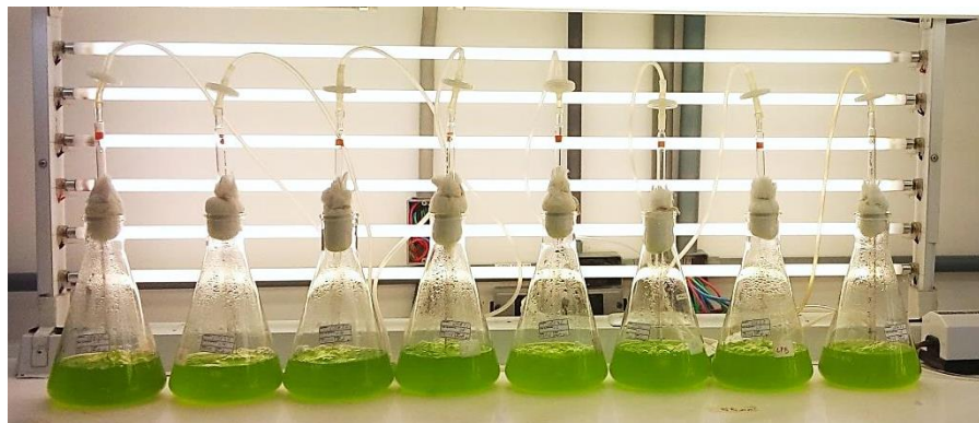
Figura 7 - Produção de inóculo em frascos Erlenmeyer de 1L sob iluminação artificial de 16.000 Lux, ciclo de iluminação 12/12 claro/escuro, temperatura de 28°C, aeração de 10Lh -1 .
