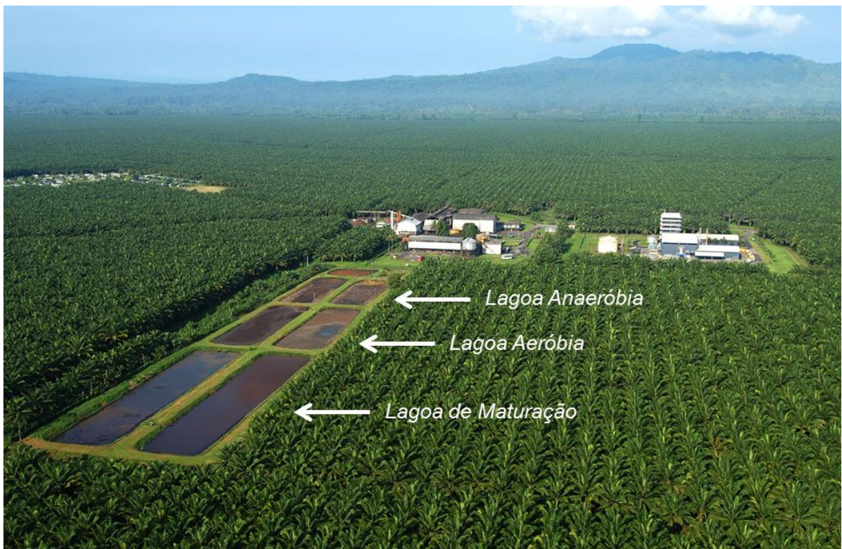
Figura 4 - Lagoas de estabilização de POME em agroindústria de palma-de-óleo em Papua Nova Guiné. A imagem ilustra como é disposto o sistema de lagoas de estabilização, no qual o processo inicia-se a partir da entrada do efluente na lagoa anaeróbia, passa para a lagoa aeróbia e por fim chega à lagoa de maturação. (Fonte: http://www.myclimate.org/carbon-offset-projects/projekt/papua-neuguinea-biogas-7141/ )
