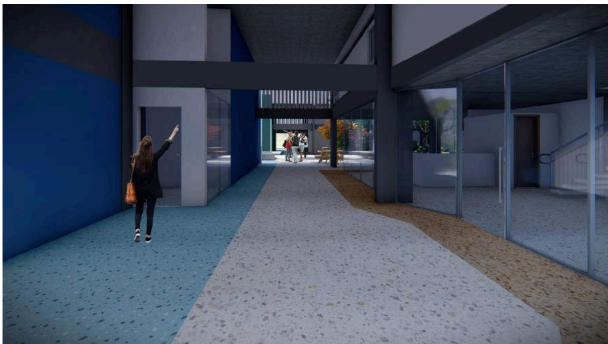
Figura 122 – Legibilidade de acessos através da paginação de piso
