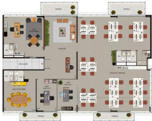
Figura 39 – Planta baixa resultante da junção de quatro salas comerciais da torre Comercial – Edifício Meet
