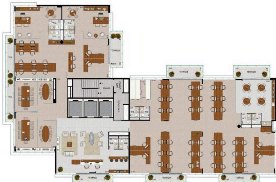
Figura 40 – Planta baixa resultante da junção de oito salas comerciais da torre Comercial – Edifício Meet
