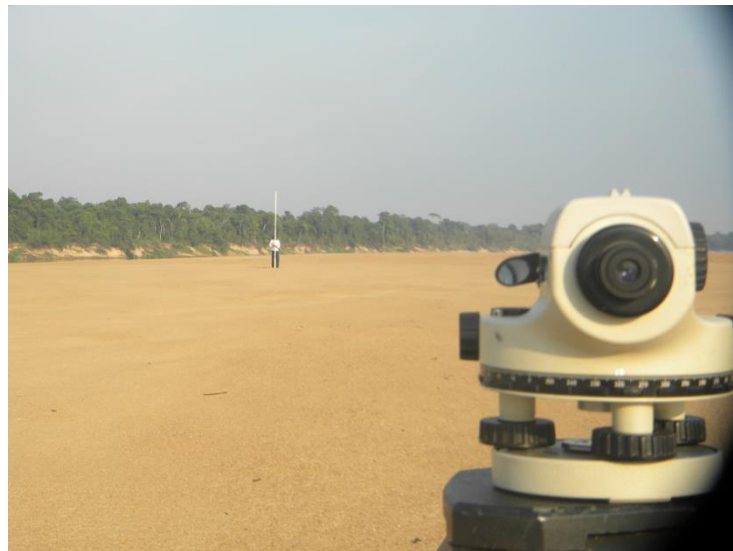
Figura 5 - Teodolito e mira posicionada para leitura de altura do terreno. Foto: Ângelo Paulo Silva Gomes.
