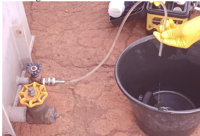
Figura 11 – Descarte de óleo no balde
