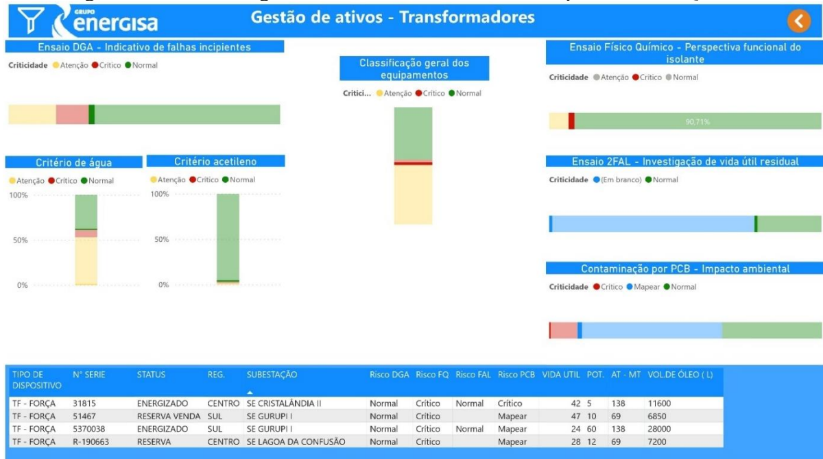
Figura 62 – Painel de gestão de transformadores filtrado para ensaio FQ crítico
