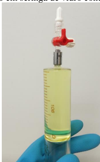
Figura 9 – Amostra de óleo em seringa de vidro conectada à válvula de três vias
