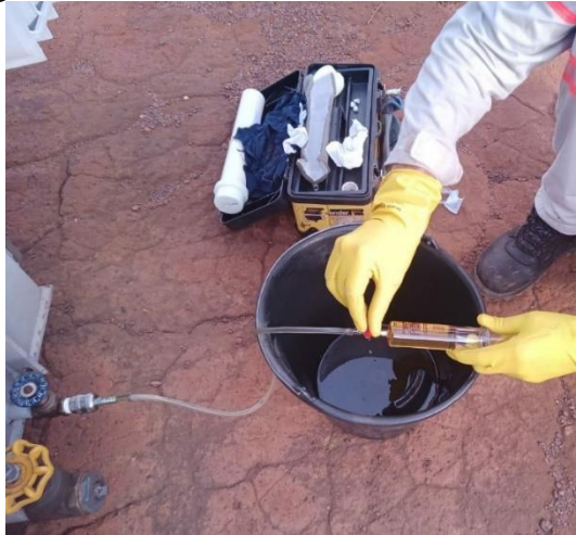
Figura 12 – Coleta de óleo isolante com seringa
