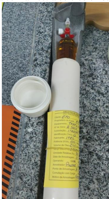
Figura 14 – Seringa com amostra de óleo embalada para transporte
