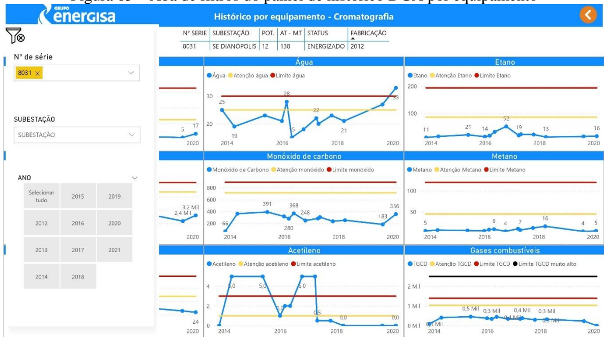
Figura 65 – Aba de filtros do painel de histórico DGA por equipamento
