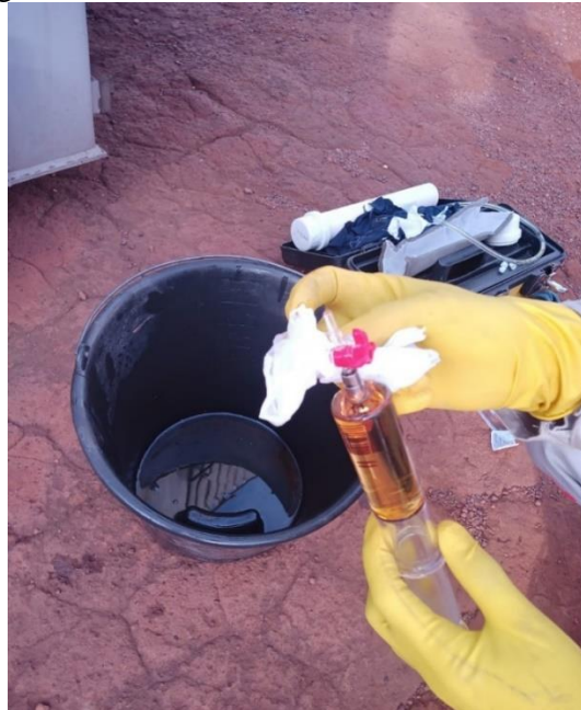
Figura 13 – Retirada de bolhas de ar da seringa
