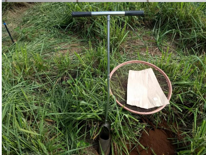
RFE 71 – Trado tipo caneco (Ø100 mm com 1,5708 dm -3 ), SondaTerra, para amostragem de raízes.
