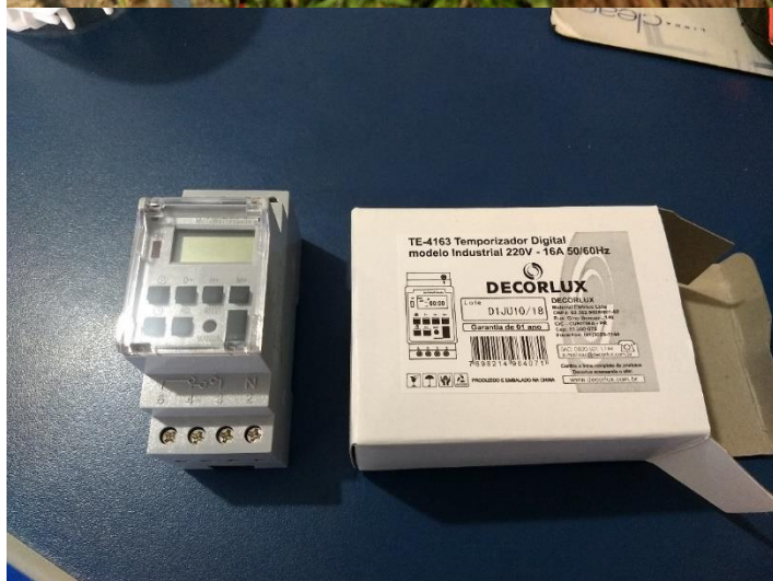
RFE 44 – Temporizador para regulagem automatizada do sistema elétrico, de 8 às 18h, de segunda-feira à sexta-feira.
