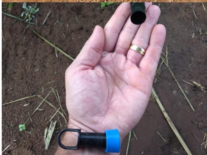
RFE 88 – Limpeza semanal no sistema, a partir da remoção do CONECTOR FINAL TYPHOON – UNIVERSAL.
