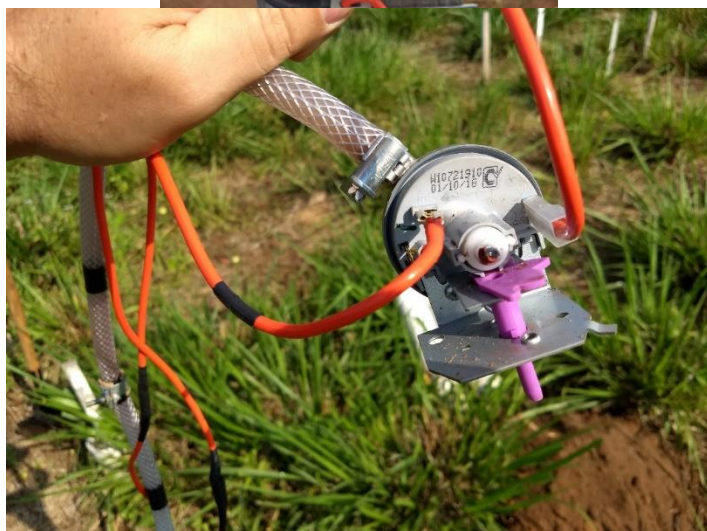
RFE 43 – Pressostato (Consul® W10721910 lavadora de 4 níveis), componente do acionador simplificado para irrigação ( MEDICI et al., 2010 ).
