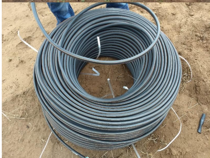
RFE 34 – Linha ramal e secundaria com TUBO CEGO PE 16012 - 400M.
