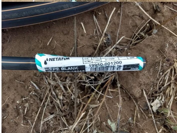
RFE 35 – Linha ramal e secundaria com TUBO CEGO PE 16012 - 400M.
