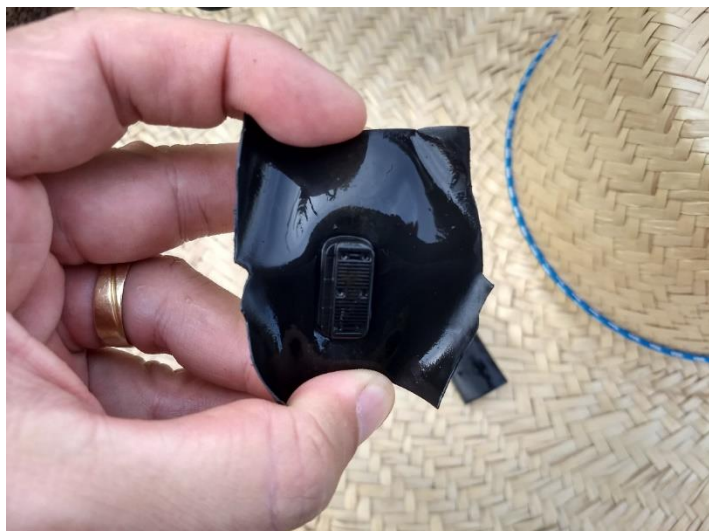
RFE 15 – Detalhe do emissor, lado interno, do tubo gotejador DRIPNET PC™ AS 16150.
