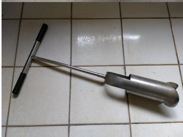
RFE 70 – Trado tipo caneco (Ø100 mm com 1,5708 dm -3 ), SondaTerra, para amostragem de raízes.
