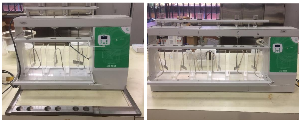
Figura 10 - Equipamento jarrest utilizado na realização dos ensaios
