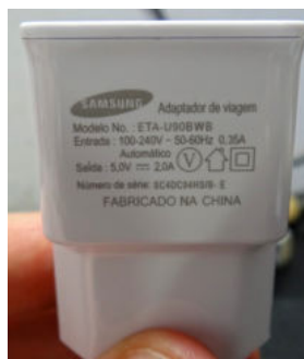
Figura 59 – Especificações de um carregador de celular. Fonte: Autor.
