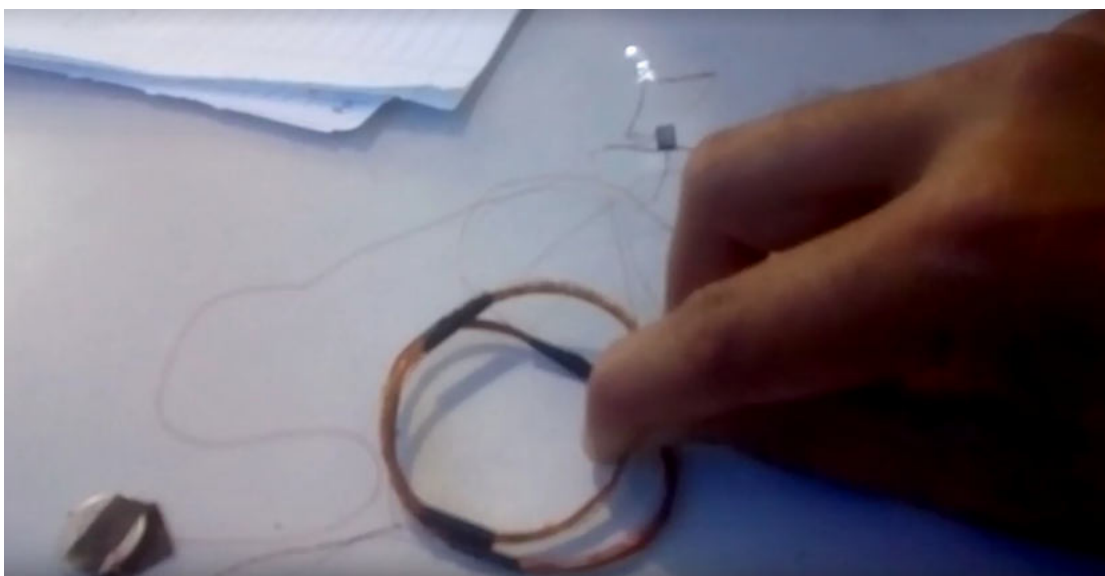
Figura 53 – Experiência: Produção do campo magnético por meio da corrente elétrica usando duas bobinas.
