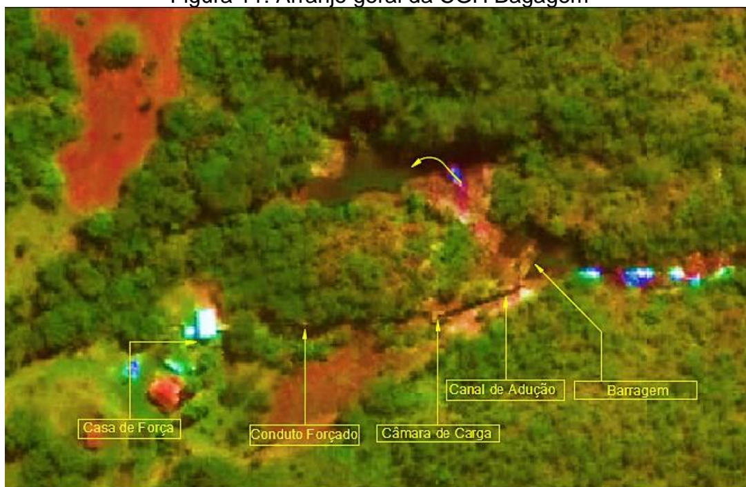
Figura 11: Arranjo geral da CGH Bagagem
