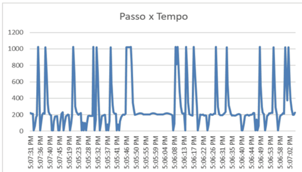
Figura 5.11: Resultados obtidos de uma movimento não linear da roda de Lorenz, obtida na planilha excel pelo program PLX-DAQ
