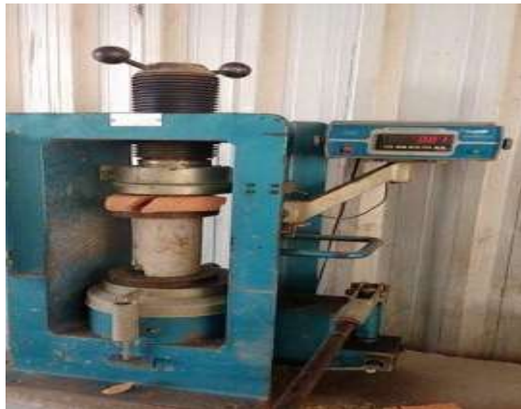
Figura 12 -Prensa com monitoramento digital, própria para compressão de resistência mínima.
