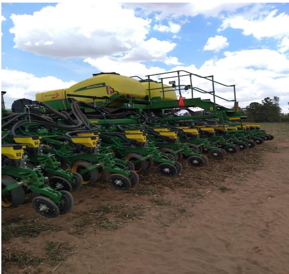
Figura 2. Semeadora pneumática a vácuo. Luís Eduardo Magalhães-BA, 2019.
