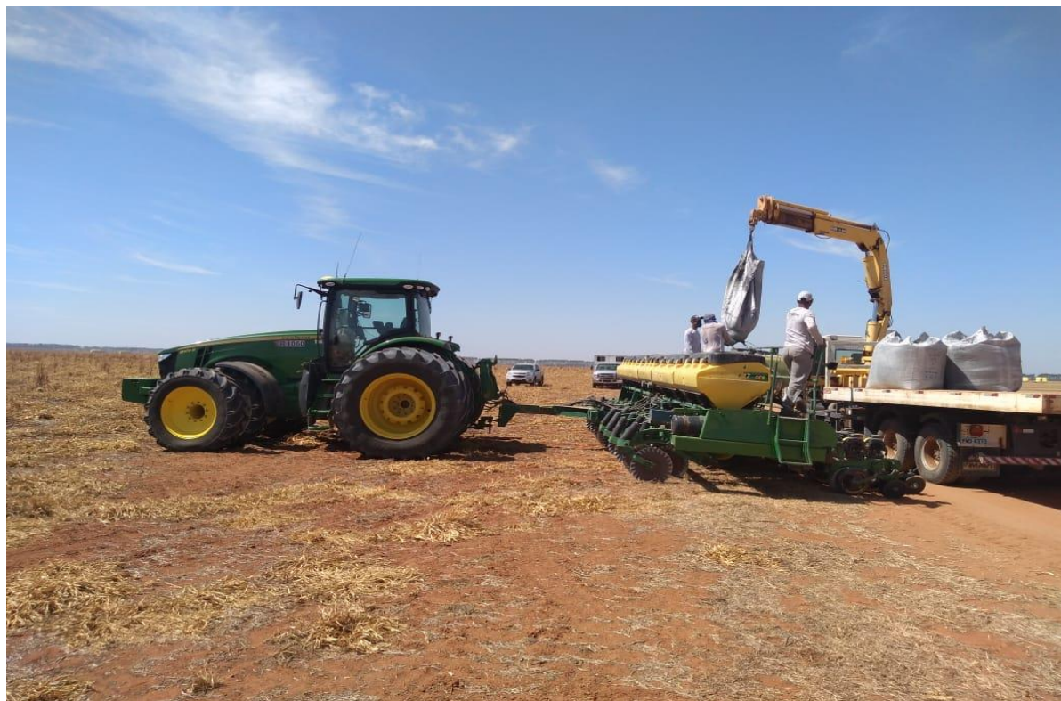
Figura 1. Semeadora utilizada no sistema de plantio direto, equipada com discos de corte. Luís Eduardo Magalhães-BA, 2019.
