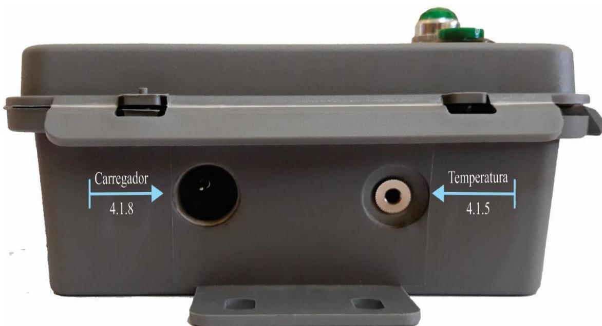
Figura 28: Conexões carregador da bateria e conector de temperatura
