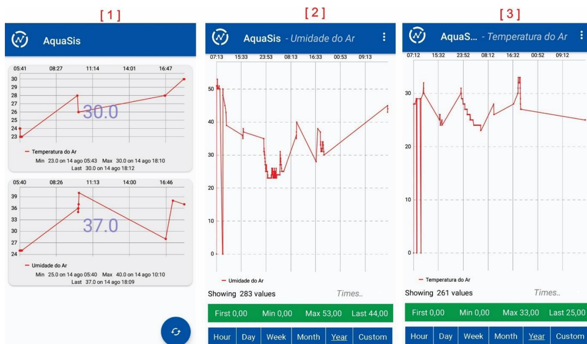
Figura 20: Dados do sensor de temperatura e umidade
