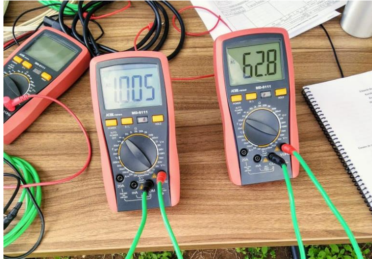
Figura 44 - Resultado da relação de espiras dos enrolamentos de baixa e alta tensão.
