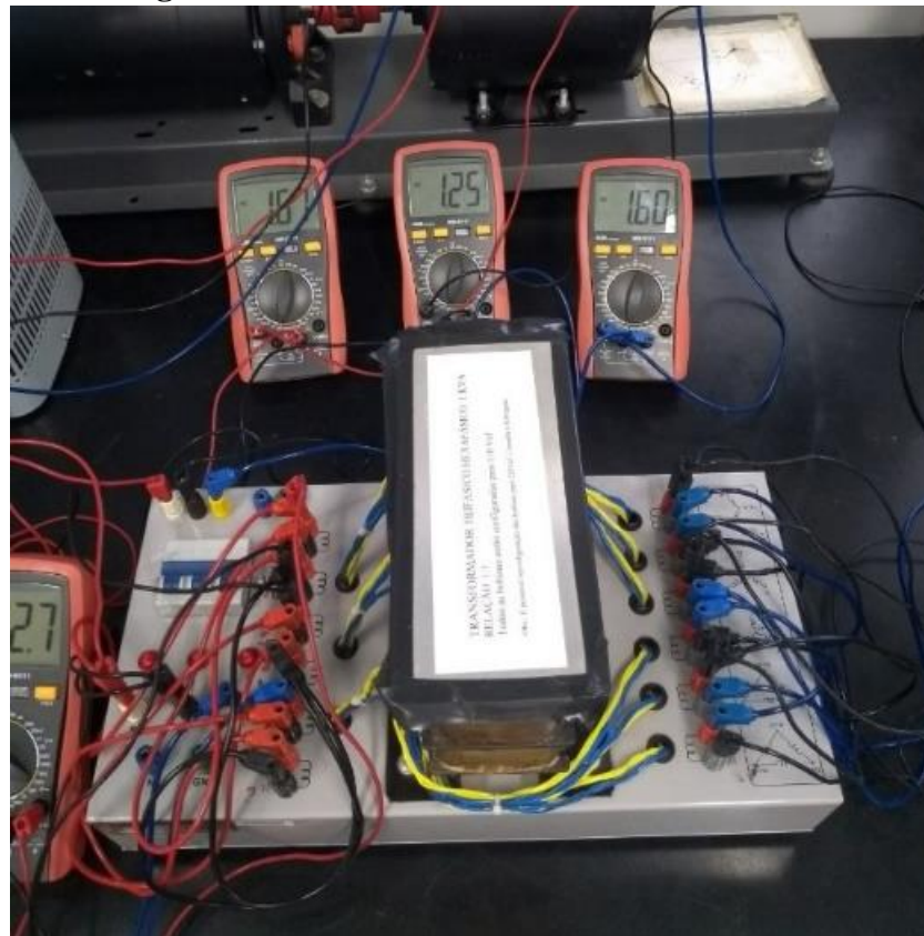
Figura 41 - Correntes de curto-circuito
