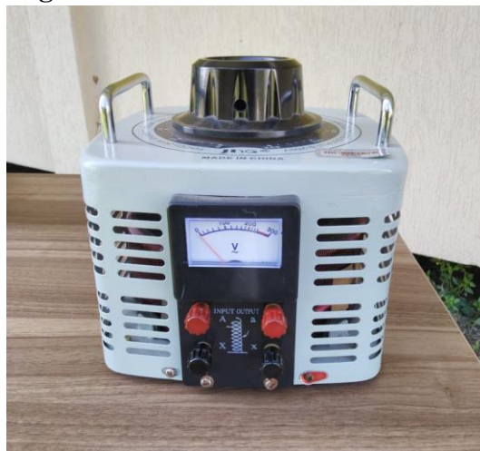
Figura 28 - Variador de tensão
