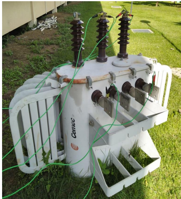
Figura 47 - Configuração do ensaio de relação de transformação
