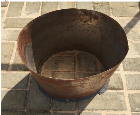
Figura 22. Cilindro fixado sobre os blocos de concreto.
