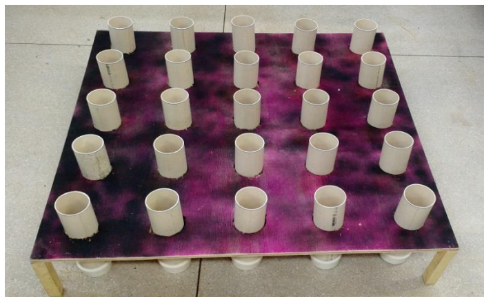
Figura 9. Forma e coletores usados para o teste do CUC.
