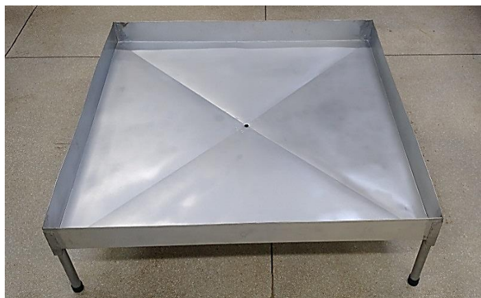
Figura 10. Forma coletora de chuva para o teste de intensidade.
