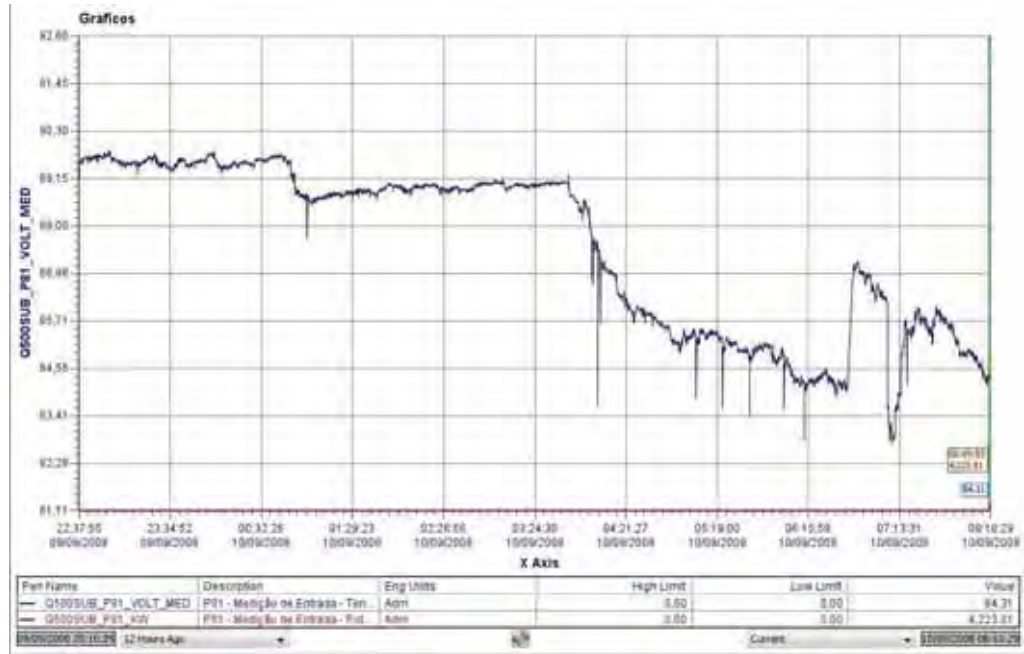
Figura 34 - Gráfico da tensão de entrada do cubículo (88kV)
