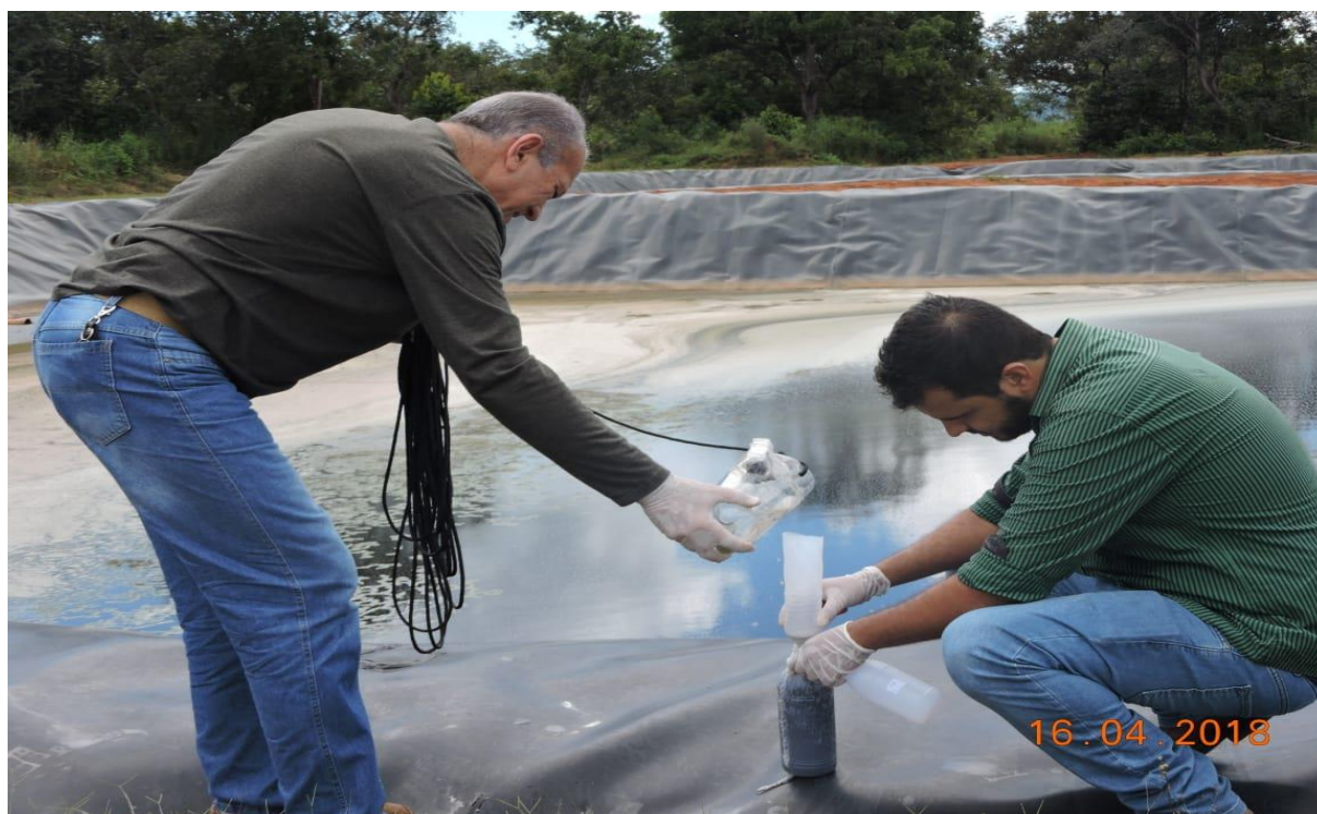
Figura 6.16: Coleta da amostra de percolado no sistema de tratamento instalado na área do Aterro Sanitário de Palmas - TO.
