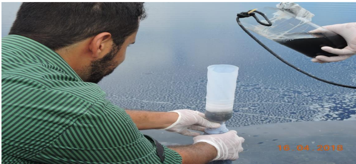
Figura 6.14: Coleta da amostra de percolado no sistema de tratamento instalado na área do Aterro Sanitário de Palmas - TO.
