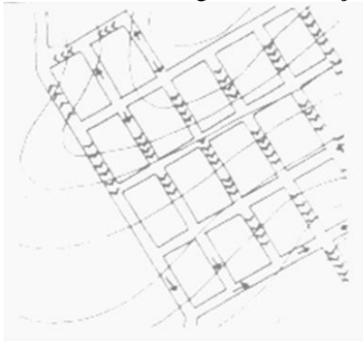
Figura 7 – Relação entre traçado viário e escoamento de águas pluviais
