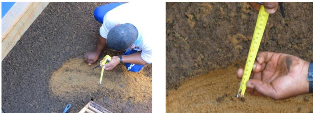
**Figura 5.15:** Medida da espessura da camada de impurezas acima do topo do material filtrante do FRD 004 após a lavagem
