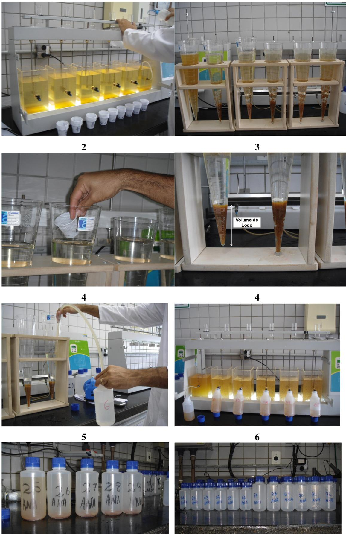
**Figura 4.20:** Sequência de realização dos ensaios de jarteste.
