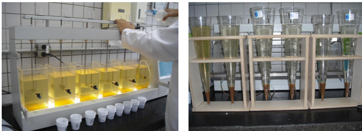
**Figura 4.19:** Equipamento jarteste e cone Imhoff, usado nos ensaios.
