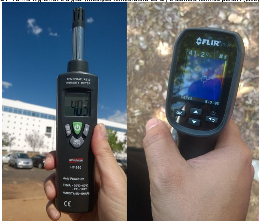
Figura 24- Termo-higrômetro digital (medição temperatura do ar) e câmera térmica portátil (piso).
